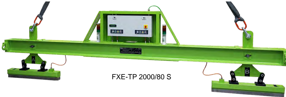
FXE-T Elektro-Permanente magneet met extra diep magnetischveld.
