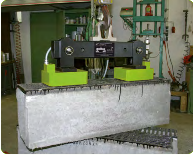
FXE-T Elektro-Permanente magneet met extra diep magnetischveld.
