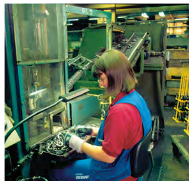
Iedere component is proefbelast en geïnspecteerd
