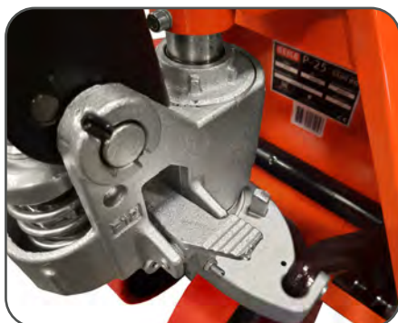
Extra voetpedaal t.b.v. gecontroleerd dalen.
